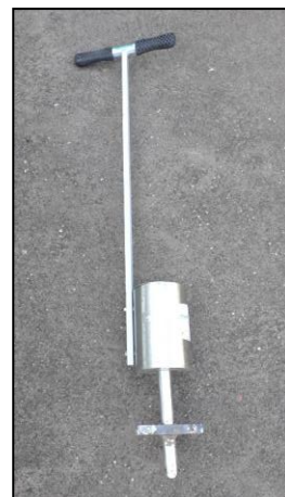
Figura 2. Barreno con tacho colector para toma de muestras de suelo.
